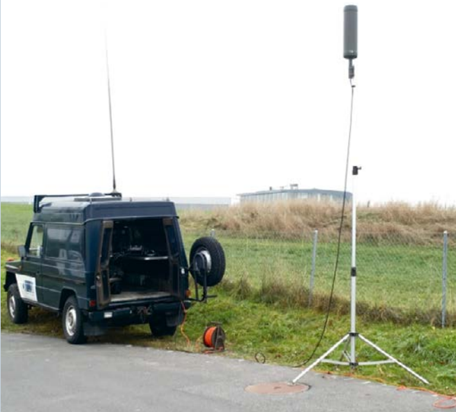
Das Messsystem kann in einen speziell für Messungen ausgerüsteten Puch Geländewagen installiert werden. Es besteht aus einem Sender, der ein speziell entworfenes Signal aussendet und einer mobilen Empfangsstation, die alle Signalanteile und deren Verzögerungen misst.
