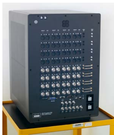
Das Messsystem kann in einen speziell für Messungen ausgerüsteten Puch Geländewagen installiert werden. Es besteht aus einem Sender, der ein speziell entworfenes Signal aussendet und einer mobilen Empfangsstation, die alle Signalanteile und deren Verzögerungen misst.
