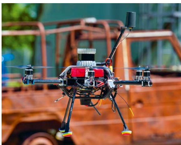
Eine Forschungsdrohne dient zur dreidimensionalen Vermessung der Umgebung. Die Karte kann anschliessend zur Planung von Missionen verwendet werden.
