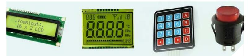
Beispiele für Bestandteile von Lowtechschnittstellen (von links nach rechts): Bildschirm mit Punktmatrix, LCD-Segmentanzeige, Membrantastatur und Drucktaste.
