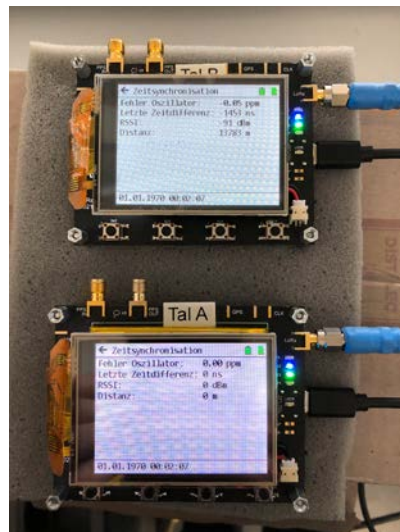
Entwickelte Hardware für die LoRa-basierte Zeitsynchronisation während der Tests über die 13 km Teststrecke von Thun auf den Niesen.
