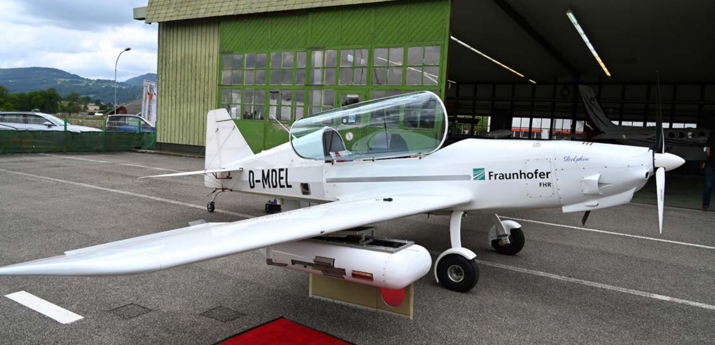
Foto des Leichtfliegers Delphin auf dem Flugplatz in Grenchen. Das Forschungsgerät MIRANDA-35 ist in dem weissen Pod unterhalb des rechten Flügels integriert.
