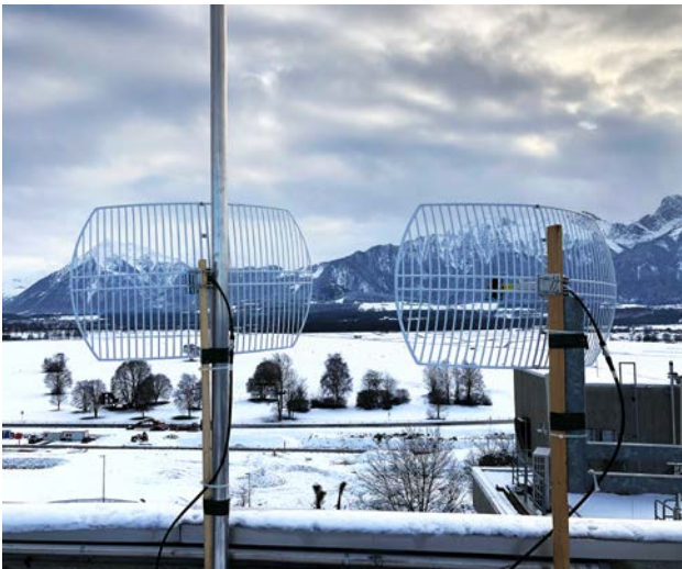
In einem Langstreckentest wird die Zeit per LoRa-Funk von Thun auf den Niesen und wieder zurück übertragen. In Thun kann dann die Genauigkeit zwischen der Originalzeit und der übertragenen Zeit gemessen werden.
