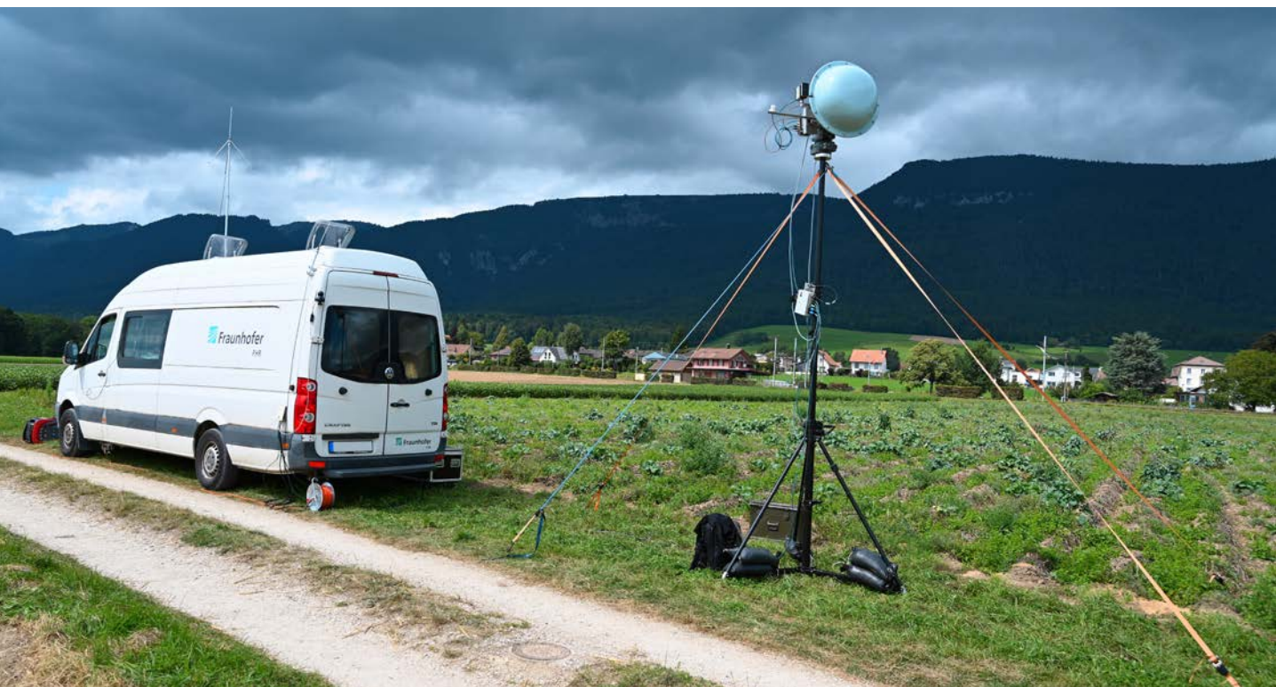
Das Forschungsgerät MIRANDA-35 wird von einer Bodenstation aus gesteuert. Hierzu dient eine Funkdatenverbindung.
