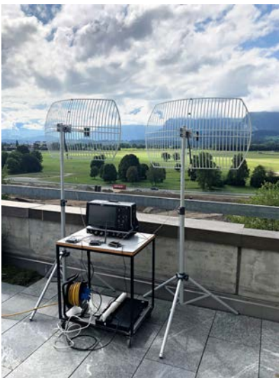
Experimentelles System für die drahtlose Zeitsynchronisation, basierend auf der «Internet of Things»-Funktechnologie LoRa. Das System zeigte eine Genauigkeit von 50 Nanosekunden über eine Strecke von 13 km.
