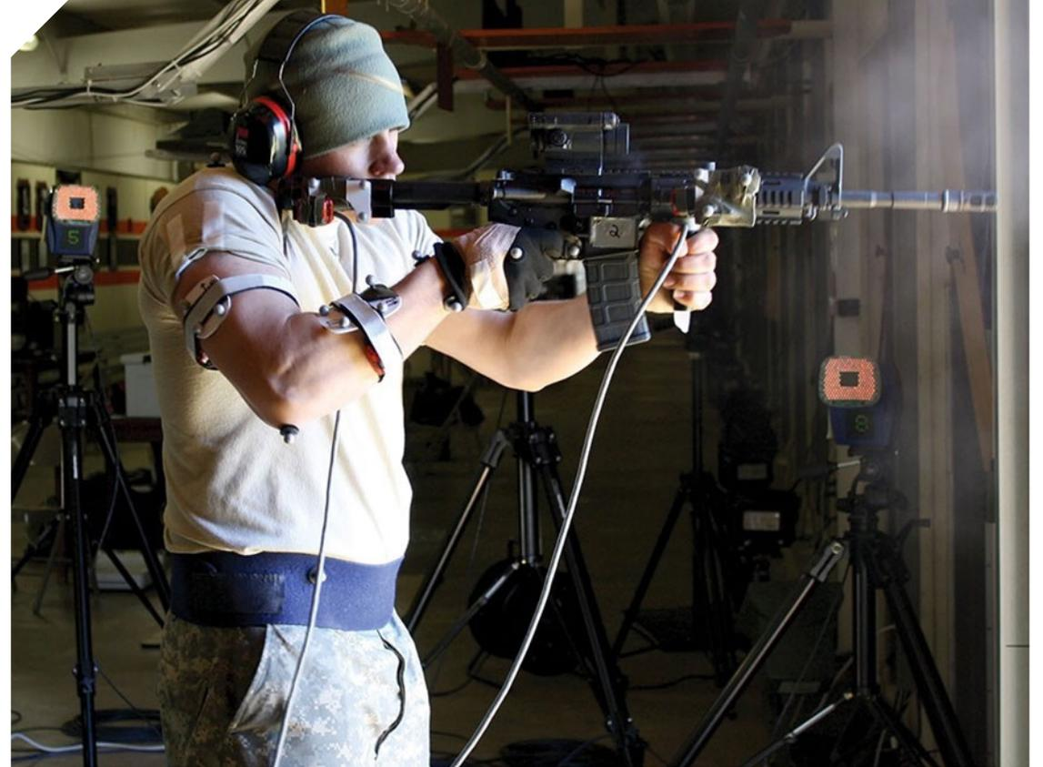
Test d'ergonomie et mesure de recul sur un fusil d'assaut, [Source : US Army](#)
