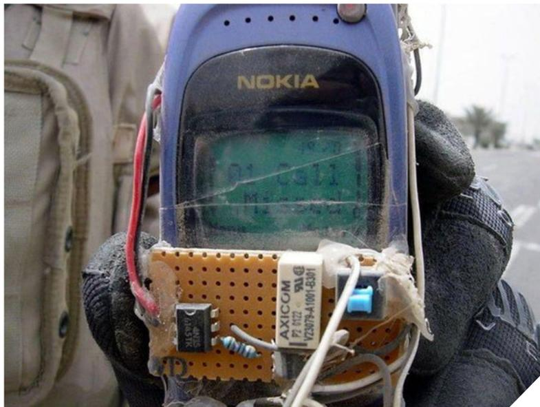
Exemple d'un EEI (engin explosif improvisé) déclenché à distance par un téléphone en Irak.
