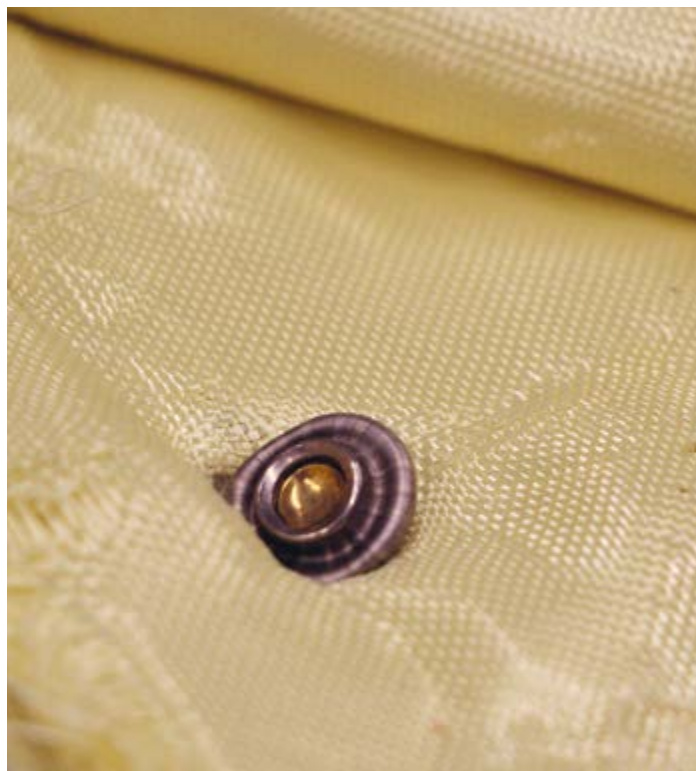
Dans ce cas, le projectile a été déformé et stoppé par le tissu balistique (fibre d'aramide).
