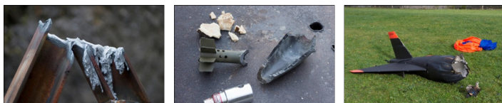
Figure 3: Résultat de l'illumination de cibles diverses par un faisceau laser de haute puissance [2].
