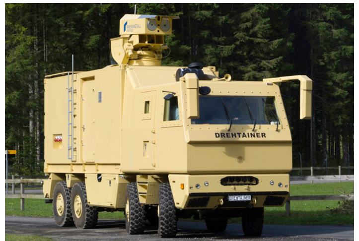
Figure 4: Démonstrateur du système laser mobile de 20 kW de Rheinmetall. On notera, sur le toit du véhicule, la tourelle avec télescopes pour deux lasers de 10 kW.
