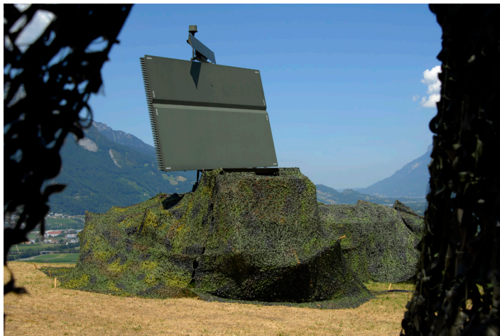
Abbildung 3: Rotierende Radarantennen werden künftig durch Antennen mit elektronisch gesteuerter Strahlschwenkung ersetzt (Bild TAFLIR-Radar der Schweizer Armee, © VBS/DDPS).
